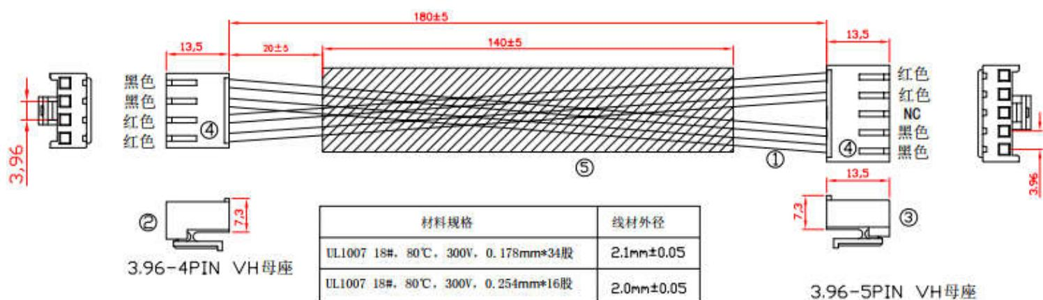
技术要求: 基板端子可焊性要满足IPC-EIA-J-STD-002A实验方法的试验要求, 线材成品拉力符合UL486A-1991要求。
